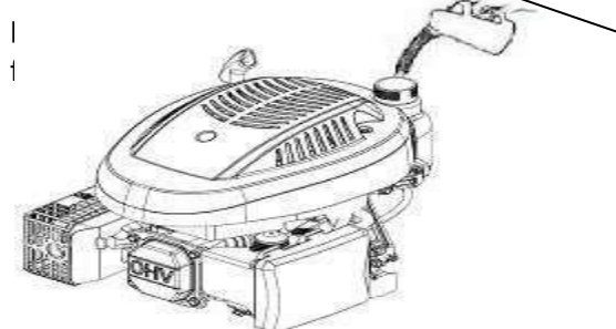
Trappe de réservoir
